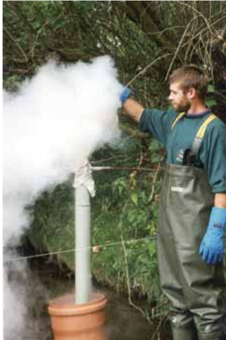
Abb. 76: Freeze-core sampler im Einsatz mit Falko Wagner in der Ilm, Sommer 2002. Foto: B. Klein.
